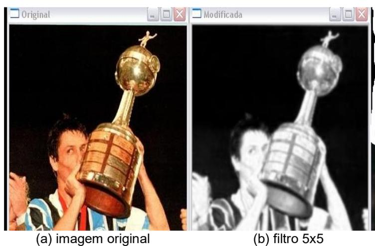
**Figura 22:** Operação de filtro Gaussiano.
