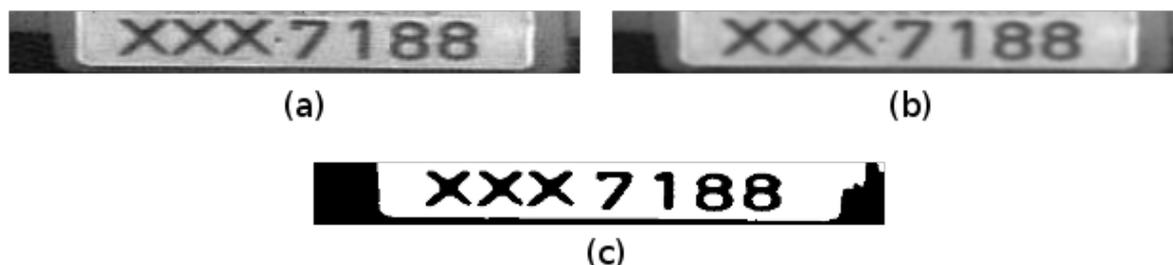
**Figura 34:** Filtros aplicados sobre a placa. (a) imagem original; (b) filtro gaussiano; (c) limiarização.
