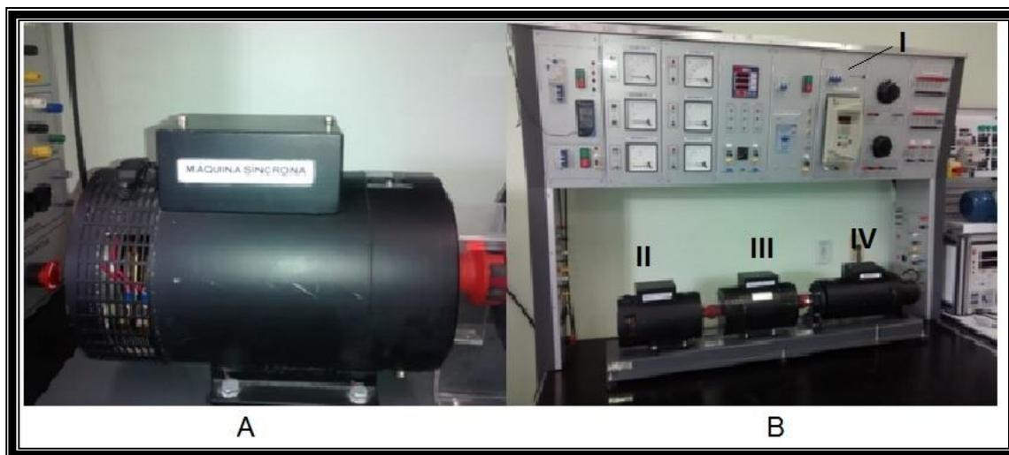
**Figura 19:** A: motor síncrono utilizado nos ensaios em detalhe. B: bancada didática de máquinas elétricas do LABCE, onde pode ser visualizado o painel de controle (I), o motor síncrono (II), o motor assíncrono (III) e o motor de corrente contínua (IV).
