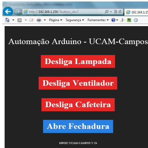
Figura 16: Interface da aplicação web com suas respectivas funções.
